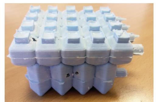
Figg. 7, 8 - Stampi in silicone per la realizzazione delle cellule e dei vuoti pneumatici.
